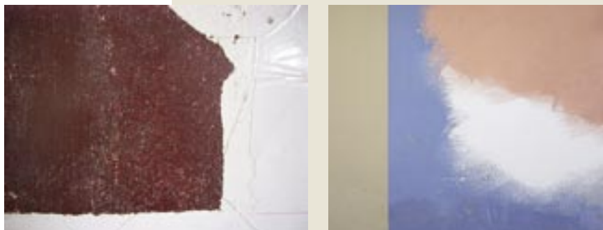
Farbbefundung am hölzernen Türblatt mit Rotfassung von 1927 (links) und Putzproben. Axonometrie des Doppel- und Einfamilienhauses von Alfred Roth mit den Farbangaben Le Corbusiers (unten).
