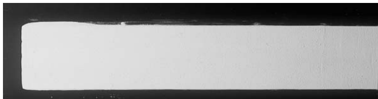
Aplicación 3: sol-silicato, pigmentado en blanco, sin aditivos de dispersión
